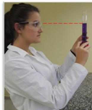
Figura 6. Posição de leitura adequada do menisco.
