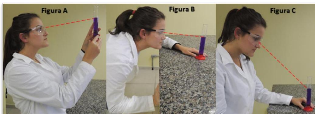
Figura 7. Posições de leitura incorretas do menisco. Figura 7.A- Leitura de volume superior ao mensurado. Figuras 7.B e 7.C – Leituras de volume inferiores ao mensurado.
