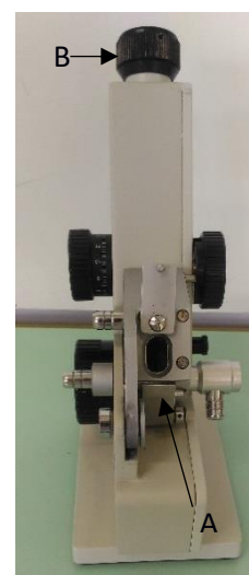
Figura 2 - Refratômetro - Visão frontal, ponto de Luz aberto
