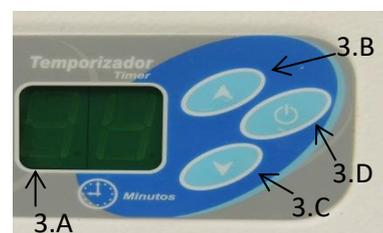
Figura 3. Painel de controle do Banho Ultrassom Ultracleaner 1400 - UNIQUE.
