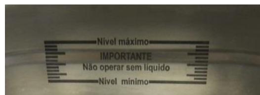
Figura 2. Indicação de nível máximo e mínimo do banho Ultrassom Ultracleaner 1400- UNIQUE.
