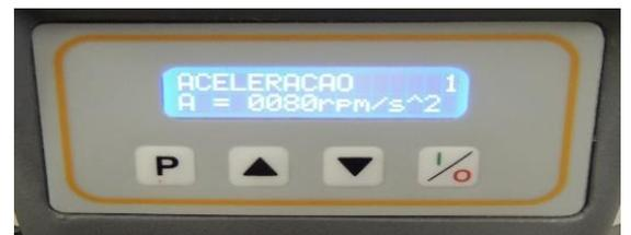
Figura 9. Escolha da aceleração no painel de controle.
