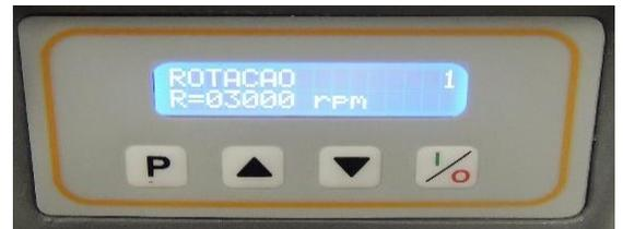
Figura 10. Escolha da rotação no painel de controle.
