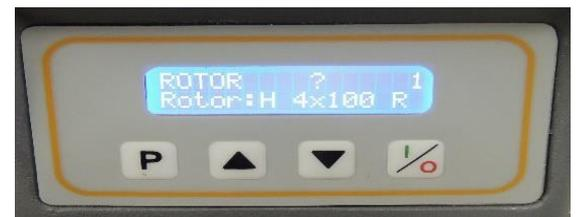
Figura 8. Escolha do rotor no painel de controle.
