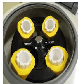
Figura 5. Rotor com os porta-tubos.
