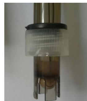
Figura 4. Ponta de prova para leitura de pH.
