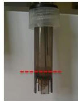
Figura 10. Limite de imersão da ponta de prova.
