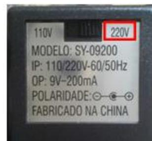
Figura 2. Seletor de voltagem.
