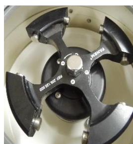
Figura 4. Visão interior da centrífuga, com o rotor A 04x100.
