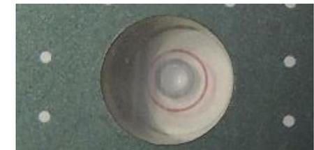
Figura 3. Bolha de nível centralizada.
