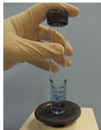
Figura 3. Formação de vórtex no interior do tubo.
